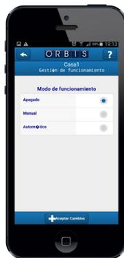
Seleccionar el modo de funcionamiento y regular temperatura manual.
