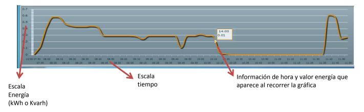
Para el modelo CONTAX D 6593 R V3x1, el único valor de curva de carga es Energía Activa Importada (kWh)
