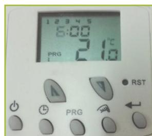
Las diferentes programaciones que el termostato trae por defecto pueden ser modificadas para ajustarse a las necesidades del usuario, pudiendo modificar tanto la hora de encendido como el valor de la temperatura deseado.
