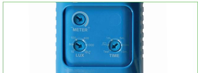
Sus tres selectores regulables de tiempo, luminosidad y sensibilidad de la distancia de detección permiten el ajuste de dichos valores adaptándose así a los rangos deseados en cada una de sus aplicaciones.
