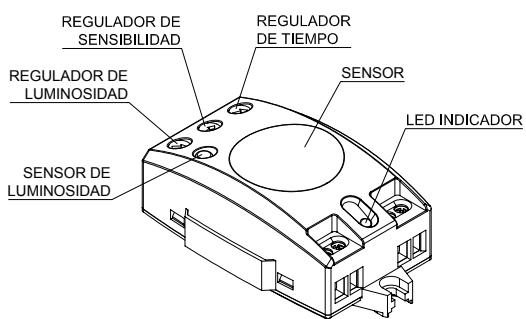
El interruptor de proximidad ECOMAT MINI es capaz de detectar el más mínimo movimiento gracias a su tecnología de alta frecuencia. Su precisión de detección no depende de la temperatura ambiente. Detecta de forma inmediata cualquier movimiento, incluso elementos inertes como por ejemplo: puertas o sillas. El ECOMAT MINI detecta en un campo de acción de hasta 10 metros con 360° de cobertura.
