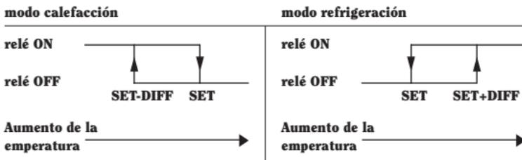
En el modo de calefacción se puede elegir la regulación proporcional que, en algunos tipos de aparatos, permite mejorar el ajuste para obtener una temperatura constante. Esta regulación acciona el relé ON u OFF dentro de un ciclo de ajuste predeterminado en función de la desviación de la temperatura medida por el valor seleccionado.
