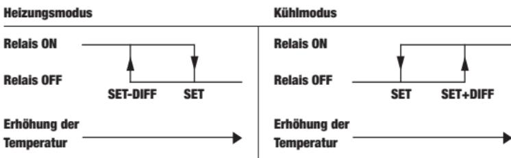
Im Heizungsmodus kann die proportionale Regelung gewählt werden, die bei einigen Geräten ermöglicht die Einstellung zu verbessern, um eine konstante Temperatur zu erlangen. Diese Regelung schaltet das Relais ON oder OFF innerhalb eines vorgegebenen Einstellungszyklus gemäß der Abweichung der gemessenen Temperatur vom gewählten Wert. Die notwendigen Parameter zur Definition dieses Modus sind:
