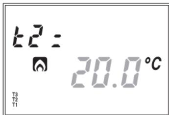
Con las teclas “**▲**” y “**▼**” se puede modificar el valor y con la tecla “**✓**” se confirma el cambio y se vuelve al funcionamiento normal.
