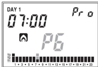
Con las teclas **T1**, **T2** y **T3** se puede modificar la temperatura seleccionada para esa hora y, al mismo tiempo, pasar a la hora siguiente. Utilizando las teclas “**▲**” y “**▼**” es posible moverse de hora en hora sin modificar la temperatura configurada.
