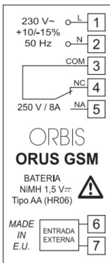
■ **ORUS GSM** es un cronotermostato electrónico semanal de pared con módulo gsm integrado que ejecuta acciones de tipo 1B y adaptado a ambientes con grado de contaminación 2 y categoría de sobretensión III (EN 60730-1).
