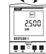
**Nota:** una vez se activa esta función, si se desea desconectar la carga antes de 9999 segundos, es necesario apagar y encender la alimentación eléctrica del instrumento.
