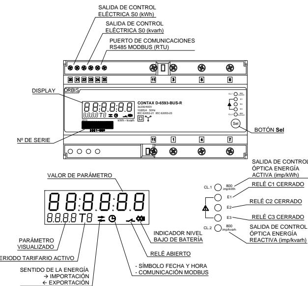
El CONTAX D-6593-BUS-R V3x1 es un contador registrador modular digital estático monofásico de directa, para la medida de energía tanto activa como reactiva con funciones de analizador de redes utilizado para la medida de la energía eléctrica en sistemas monofásicos de corriente alterna con una tensión de 230 V~ y una corriente máxima de 65 A por fase.
