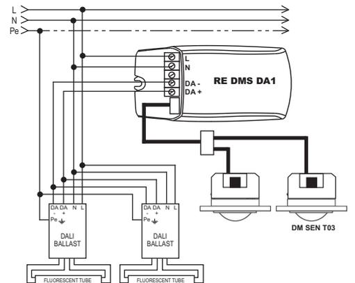
**Nota:** al alimentar el regulador, después de un apagado, las lámparas se encenderán a su nivel máximo. El sistema se autorregula al nivel de luz ajustado con cierta inercia. Esta inercia es de, aproximadamente, 10min para pasar de un nivel de encendido máximo (100%) al mínimo (<10%).
