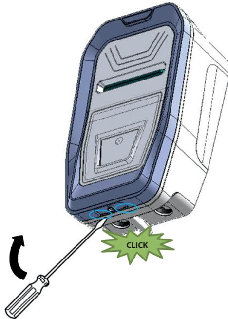
Figura 3:Apertura del equipo, Paso 2.
