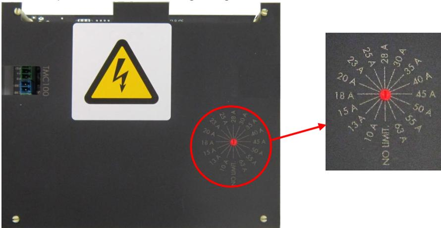
La posición del rotativo define la corriente máxima de la instalación, este parámetro se debe configurar según la potencia contratada en la instalación como se muestra en la tabla siguiente.
