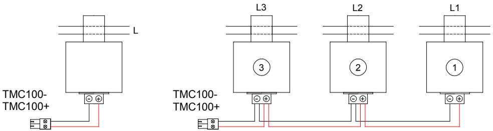
Conectar la salida del **TMC100** al conector enchufable que se suministra y conectar en el circuito de control del VIARIS COMBI.
