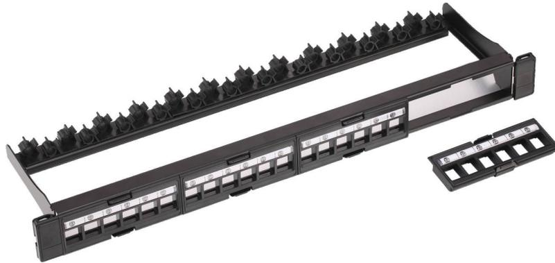
Patch panel vacío de 1U para rack 19", de 24 x RJ45 UTP Keystone, desmontables en grupos de 6 para un montaje más fácil de los conectores.
