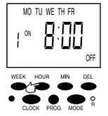
d. Pulse la tecla "MIN" para seleccionar los minutos de inicio, si mantiene pulsada la tecla más de 3 segundos el proceso se acelera.
