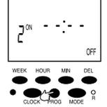
g. Pulse la tecla "CLOCK" para salir de la configuración de programación y volver a la hora actual.
