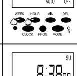
c. Para cancelar el modo aleatorio pulse a la vez las teclas "WEEK" y "HOUR", el símbolo "R" desaparece de la pantalla. El programador funcionará con la configuración anterior.
