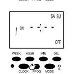
c. Pulse la tecla "HOUR" para seleccionar la hora de inicio, si mantiene pulsada la tecla más de 3 segundos el proceso se acelera.
