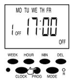
f. Pulse la tecla "PROG" para establecer la siguiente configuración de encendido y apagado que necesite. Puede establecer hasta 20 programaciones distintas.
