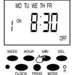
e. Una vez terminada la configuración de encendido de la 1ª programación "1 ON" pulse la tecla "PROG" para comenzar la configuración de apagado. En la pantalla aparece "1 OFF". Repita los pasos b, c y d para finalizar la configuración de la 1ª programación.
